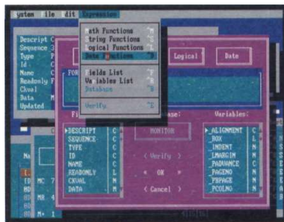
Рис. 2.: Пакет FoxPro имеет многооконный интерфейс с использованием мыши, близкий к стандарту CUA. Он позволяет использовать вместо традиционной командной строки "выпадающие" меню и "выскакивающие" диалоговые окна, однако в окне Command можно по-прежнему вводить команды в ответ на приглашение-точку.
